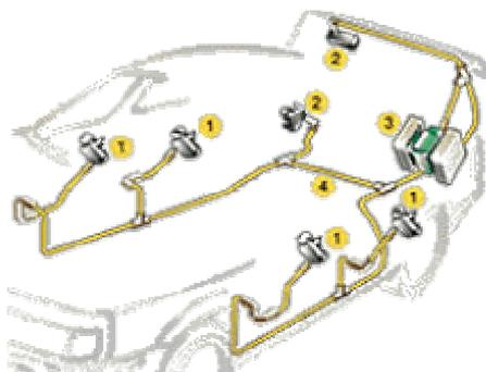
Рис. 3. Расположение пневмоузлов и магистралей в автомобиле: 1 – ДИМ; 2 – исполнительные механизмы крышки топливного бака и крышки багажника; 3 – насос с электронным блоком; 4 – пластмассовая трубка.
