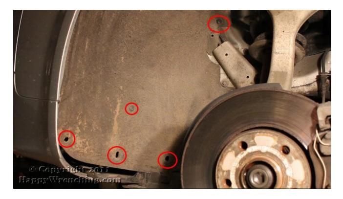
5. Отогнуть подкрылок и открутите винт TORX и три гайки (как показано на рисунке).
