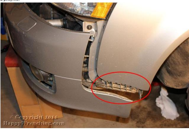
7. Прежде чем полностью снять бампер, необходимо отключить быстросъемные разъемы насосаомывателя фар электрической части и воды.
