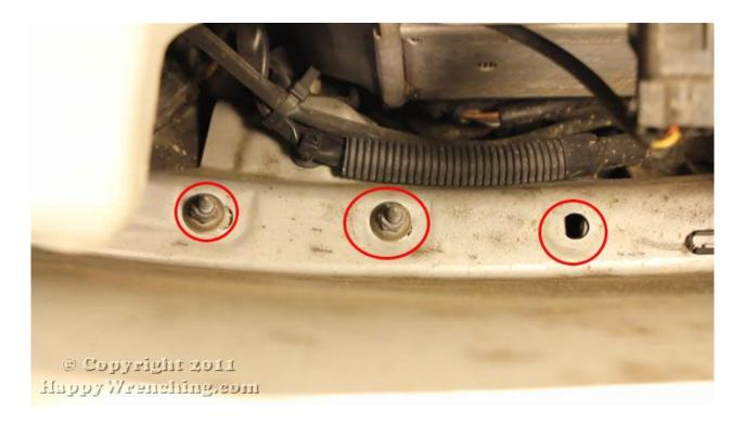
6. Используйте плоскую отвертку, для того чтобы отстегнуть боковую часть бампера, которая обведена на рисунке.
