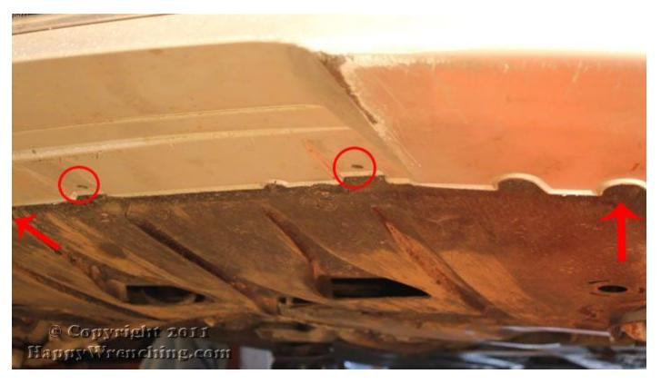
4. Снять передние колеса, для получения доступа к передним аркам. Снять весь крепеж передней части подкрылка.
