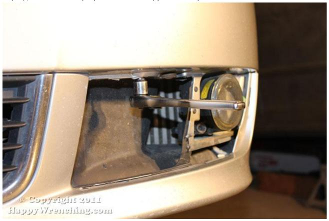
3. Удалить винты крепления пыльника двигателя.
