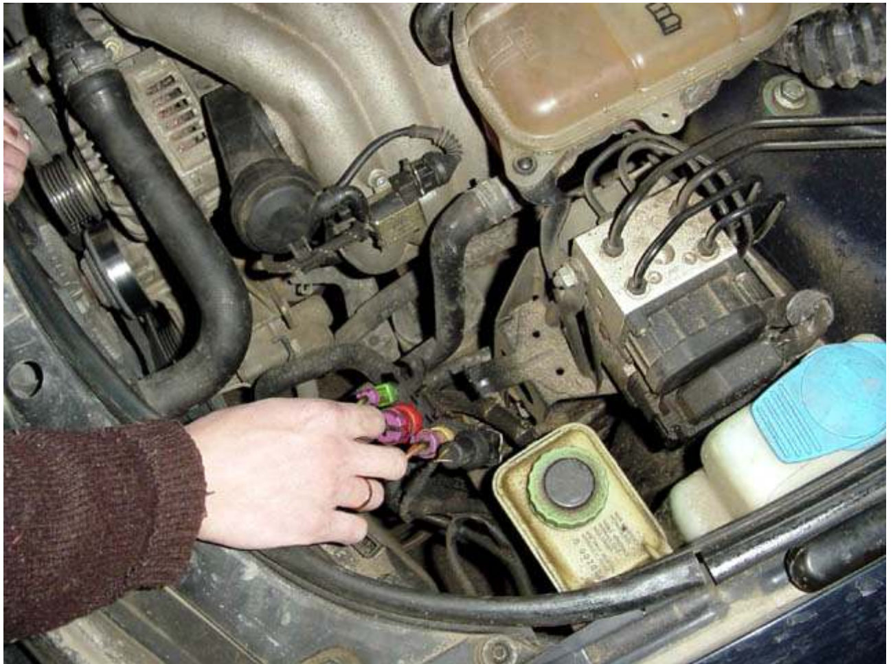
12. Вытаскиваем генератор из паза - потребуется некоторое усилие :)
