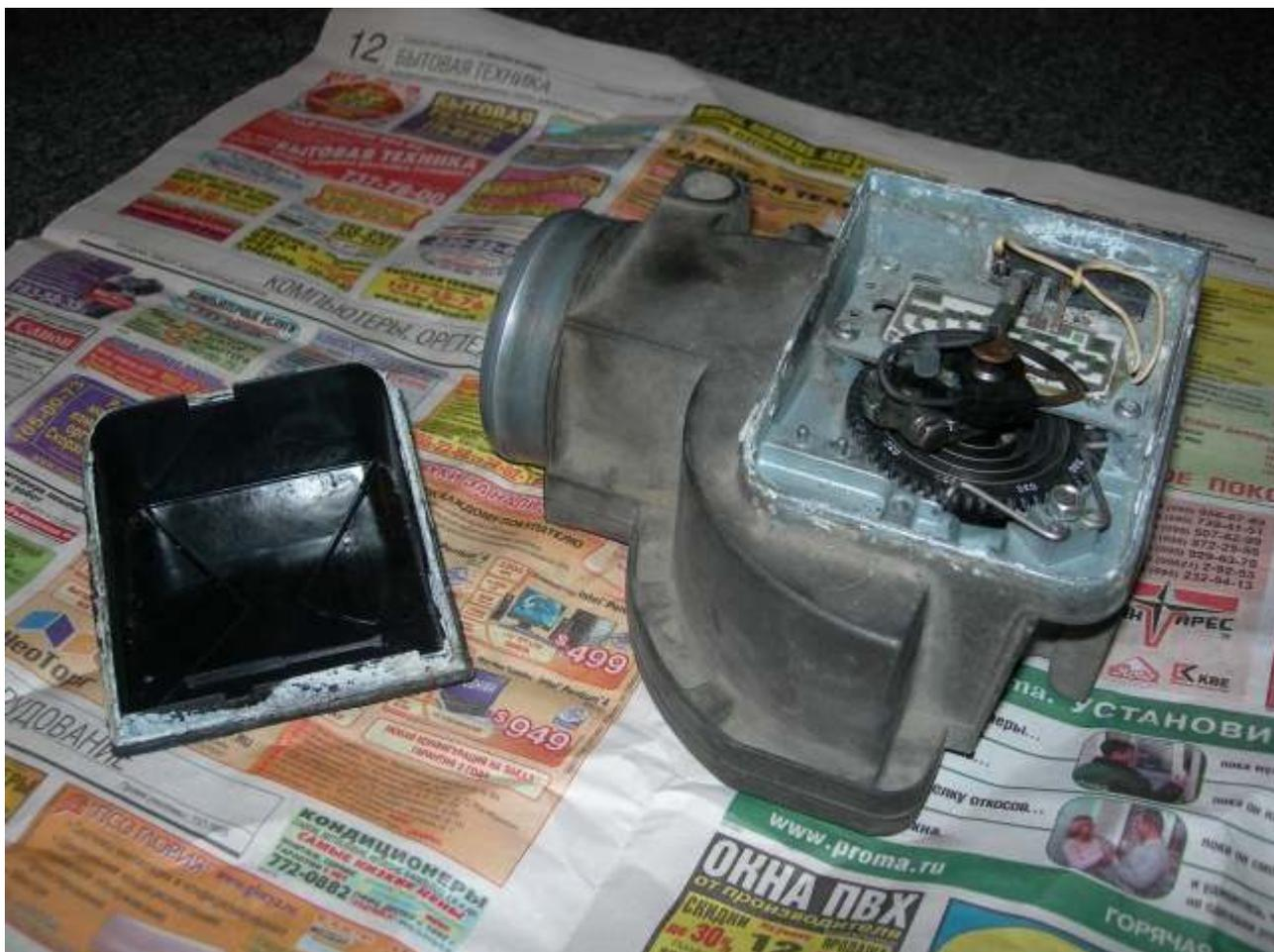
*Общий вид расходомера со снятой крышкой*
