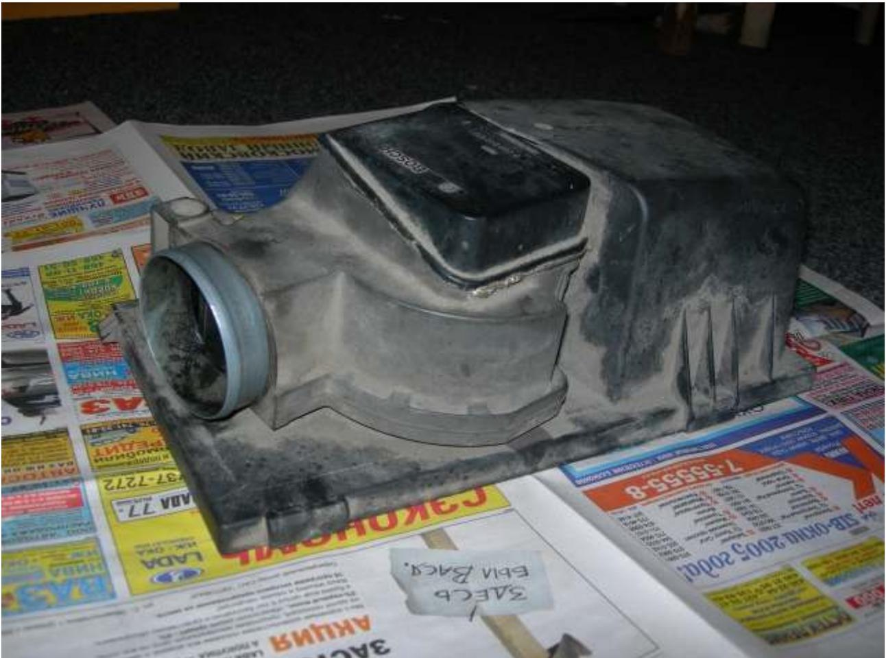
*Общий вид снятой крышки воздушного фильтра*
