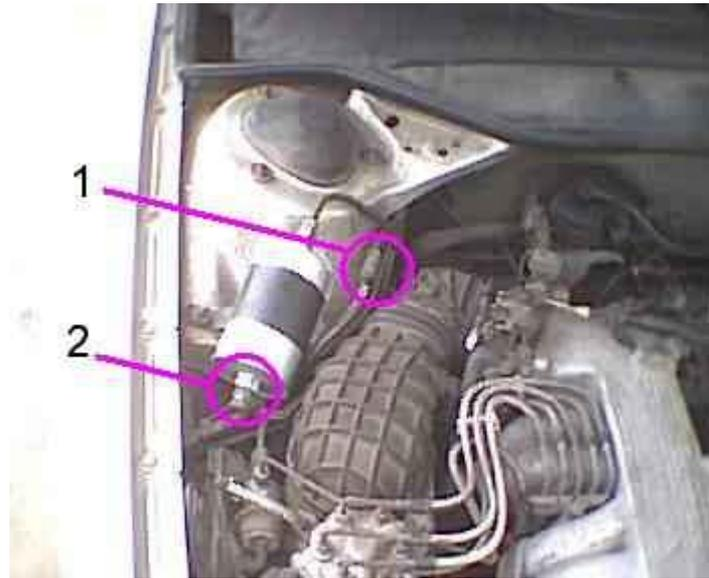
Рис.1: 1 - место возможного подключения для измерения производительности топливного насоса, 2 - место подключения для измерения рабочего давления в системе
