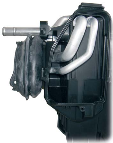
серийный комплект трубок, на примере испарителя
