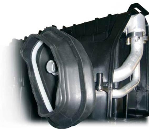
приворачиваемый комплект трубок, на примере испарителя
