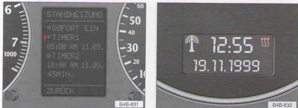
Ввести **Einstellen** → **Standheizung** (настройка → автономный отопитель) или **Einstellen** → **Standlüftung** (настройка → автономный вентилятор). На дисплее появляется меню настройки.
