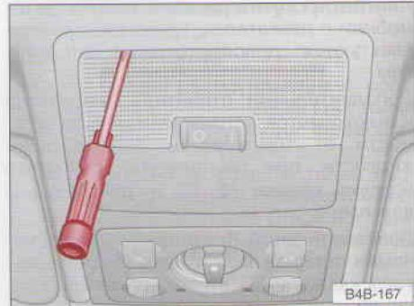
Для доступа к серводвигателю сдвижной панели крыши снять плафон (стекло и корпус) следующим образом:
