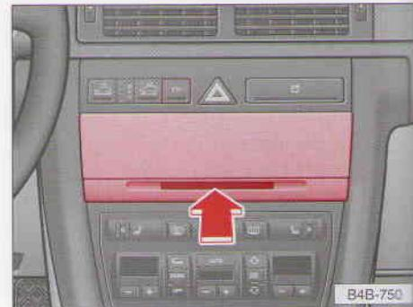
Радио закрыто пластино<sup>1)</sup>. Для доступа к радио нажать пластину.
