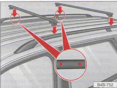
Передние и задние траверсы должны устанавливаться между метками, нанесенными на лонжеронах. Метки видны с внутренней стороны лонжеронов.
