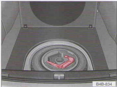
Откройте багажник и из ниши запасного колеса извлеките шаровую головку.
