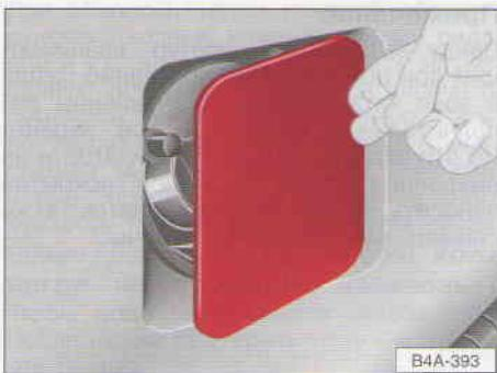
Система замков с центральным управлением обеспечивает автоматическое отпирание и запирание откидной крышки заправочного люка.
