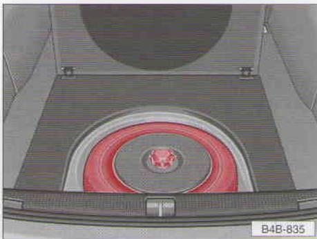
Автомобиль комплектуется специальным (накачиваемым) запасным колесом и компрессором.
