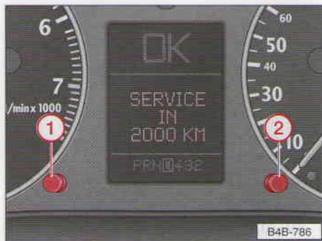
На иллюстрации изображен дисплей комбинации приборов с индикацией предстоящего техобслуживания.
