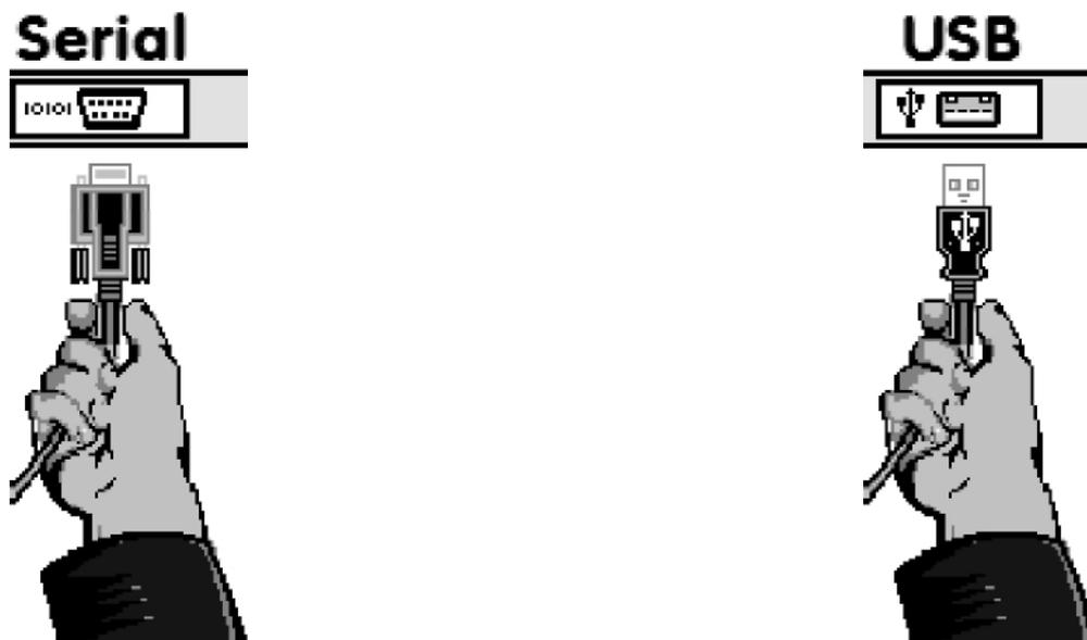
▲ Подключите разъем последовательного или USB интерфейса адаптера к соответствующему порту на вашем PC. Если ваш PC находится далее от транспортного средства более чем на 6 футов, используйте Удлинитель между PC и Адаптером.
