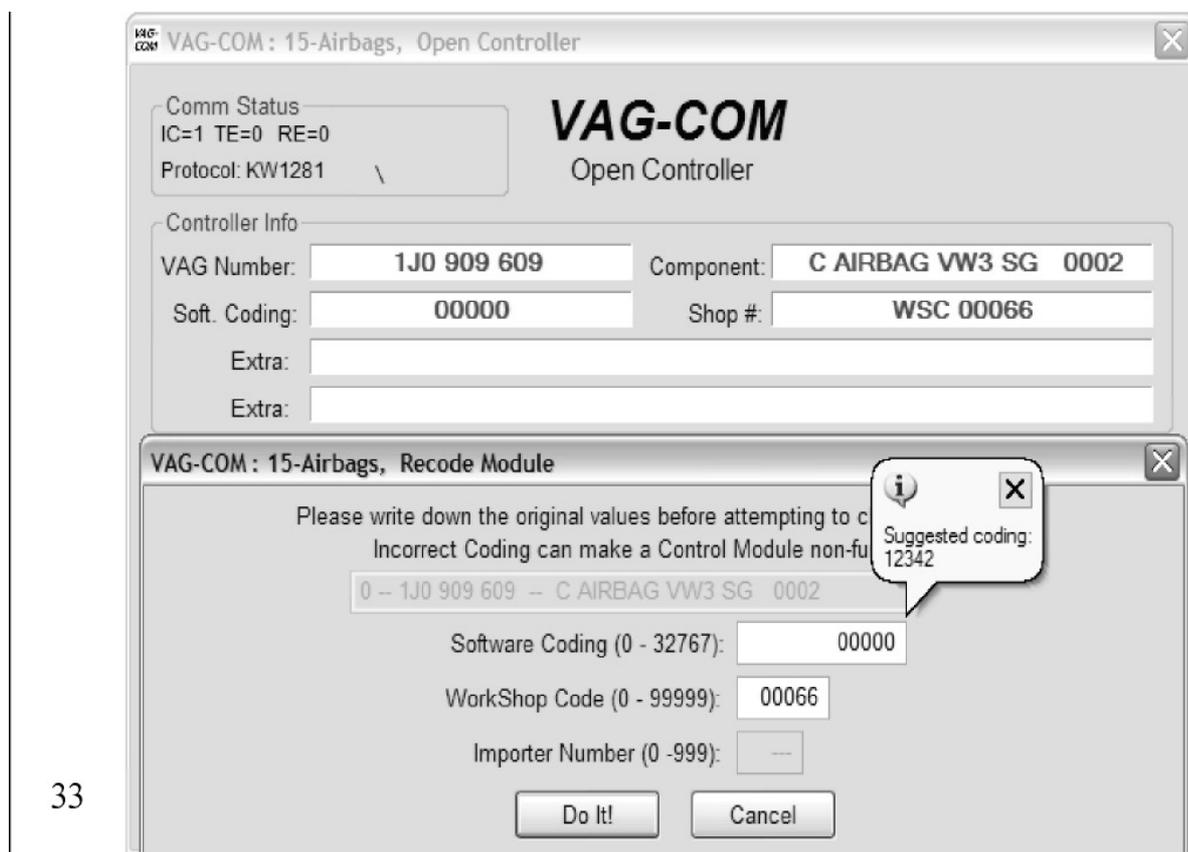
В случае где VAG-COM предложил бы кодировать Контроллер Подушки безопасности, но не может определить Указателя автоматически, VAG-COM дает Вам способность вручную ввести Индекс (найденный на ярлыке контроллера Подушки безопасности или порядке работы), чтобы получить предложенное кодирование.
