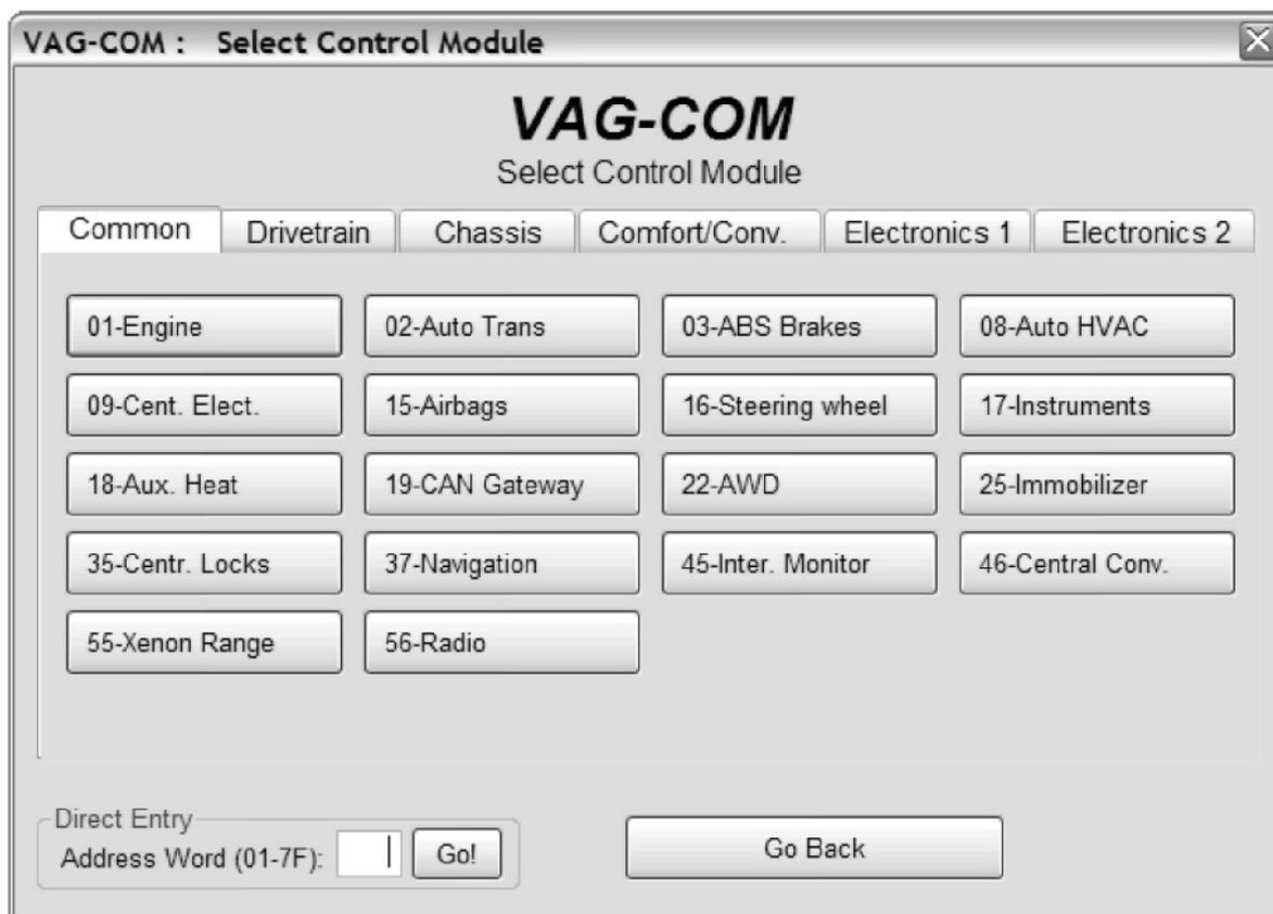
Различные компьютеры в автомобиле названы "Модулями Управления" или "Контроллерами". На этом экране, Вы выбираете контроллер, с которым хотите установить связь. Чтобы связь с конкретным контроллером, просто щелкните на соответствующей кнопке. Например, щелкните на кнопке **[01- Engine]** для подключения к контроллеру двигателя. VAG-COM имеет кнопки для всех адресов контроллеров, в настоящее время поддерживаемых дилерскими приборами диагностики VAG 5051 и VAS 5052.
