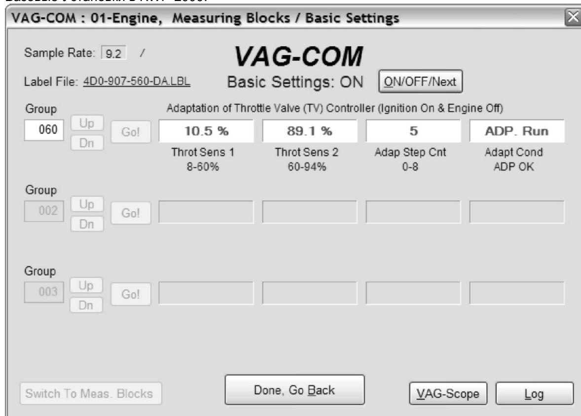
В контроллерах, использующих протокол **KWP-2000**, имеется кнопка **[ON/OFF/Next]** которая позволяет Вам инициализировать **Basic Settings** и выходить из них в то время как все еще есть возможность видеть измеряемые значения в измерительных группах.
