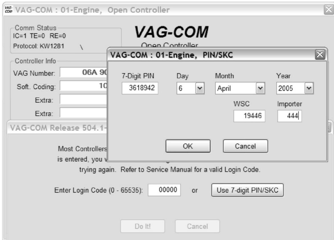
7-и значный **PIN/SKC** (секретный код) используется для согласования ключа и иммобилайзера в режиме Адаптации.
