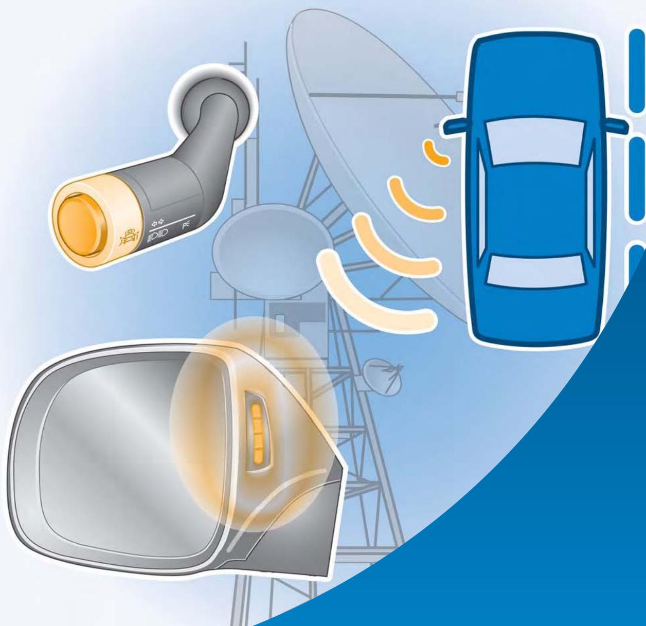
Продолжением технических инноваций в области вспомогательных систем управления стало внедрение ассистента смены полосы движения. Система служит для предотвращения дорожно-транспортных происшествий.
