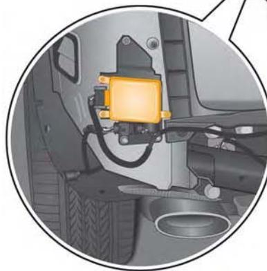
Блок управления ассистента смены полосы движения J769 за бампером, слева
