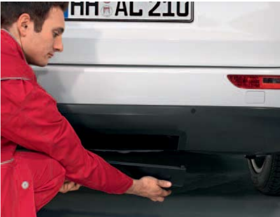
Для перемещения ТСУ с выдвижной шаровой головкой в рабочее положение необходимо сначала снять защитную накладку в середине диффузора.
