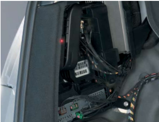
При неправильной фиксации ТСУ контрольная лампа за накладкой левой боковины багажного отсека горит красным светом.
