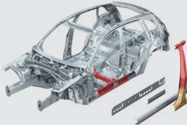
Ремонт стойки В и внутреннего элемента порога.
