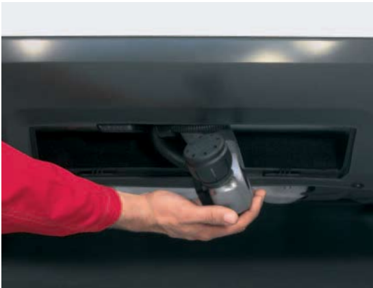
Выдвинутую шаровую головку переместить от руки в зафиксированное положение.
