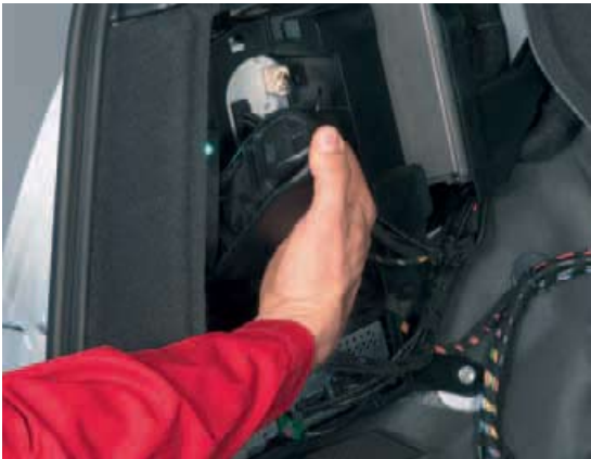
Затем деактивировать блокировку за накладкой левой боковины багажного отсека. При деактивации блокировки шаровой головки зелёный свет светодиодной контрольной лампы меняется на красный.
