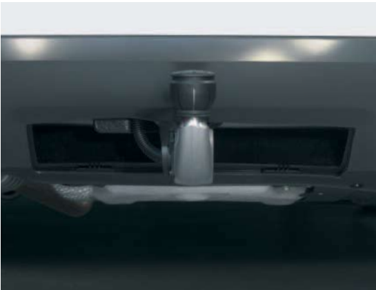
Выдвижная шаровая головка ТСУ располагается в вертикальном положении и зафиксирована надлежащим образом.
