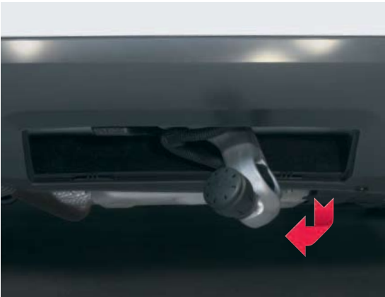
После этого шаровая головка автоматически выдвигается.
