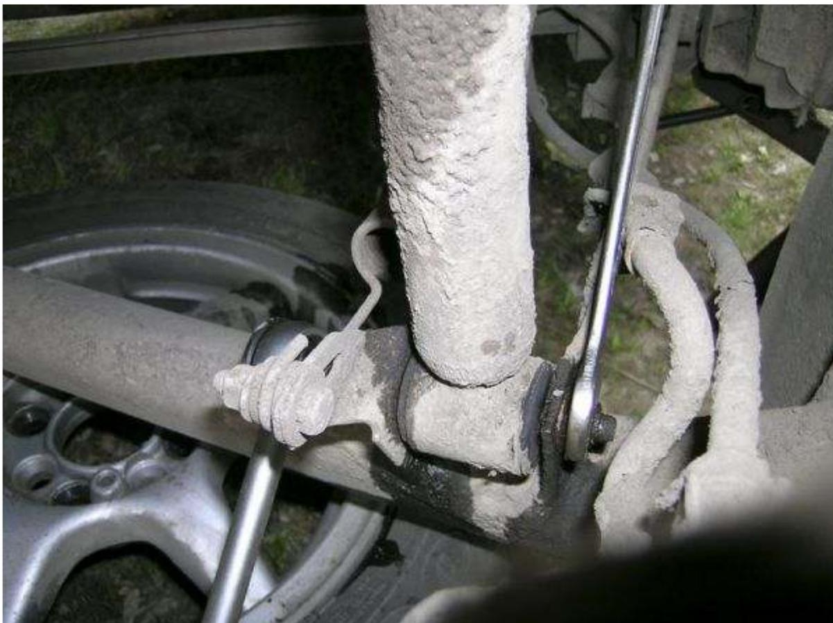
6 Когда гайка свинчена, винт вынимается довольно легко - это можно сделать рукой, подергав при этом амортизатор. Пока не вынимайте его.
