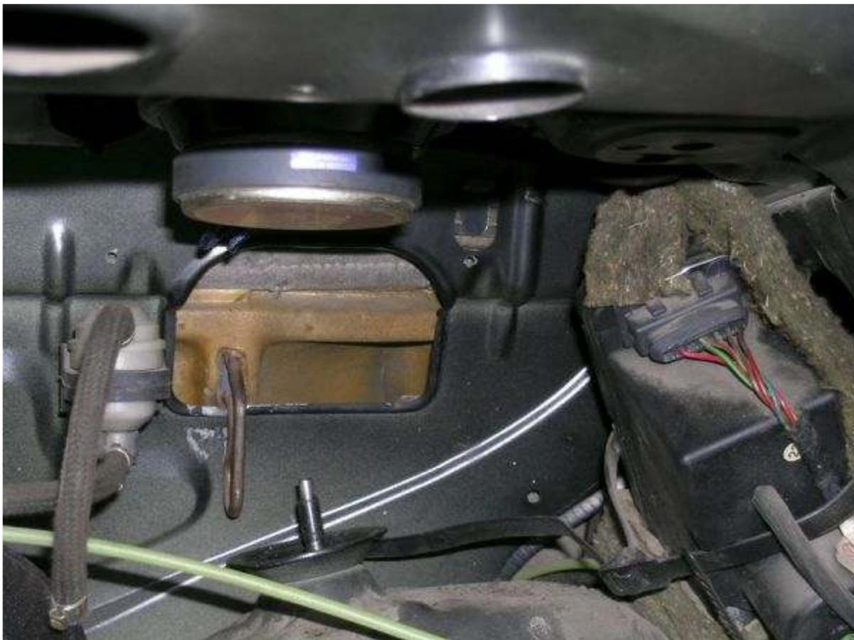
9. Когда гайка свинчена нужно аккуратно снять широкую шайбу и резинку-отбойник. Запомните какой стороной они лежали!!!
