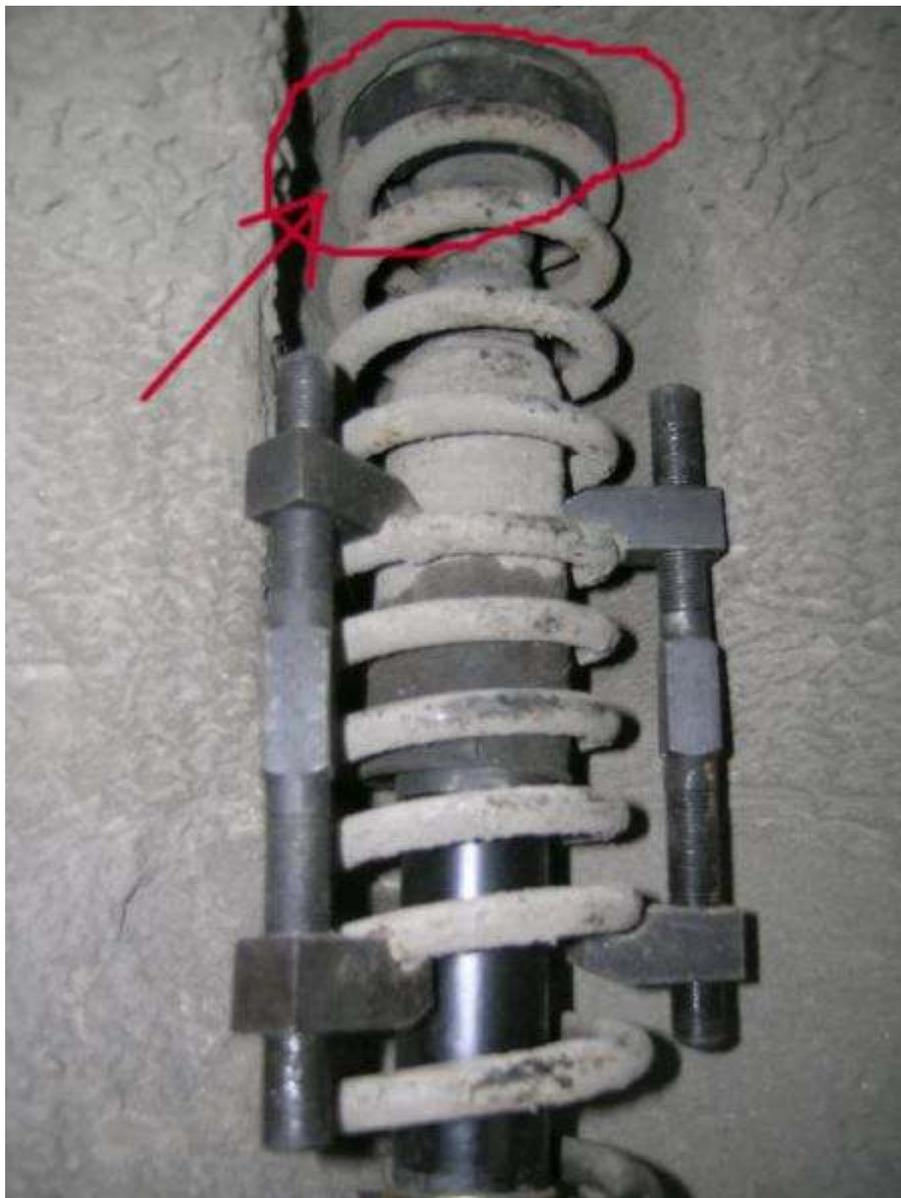
20. Снять стяжки с пружины, одеть колесо и опустить машину так чтобы верхняя ось аммо вошла в верхнюю дырку по самый отбойник.
