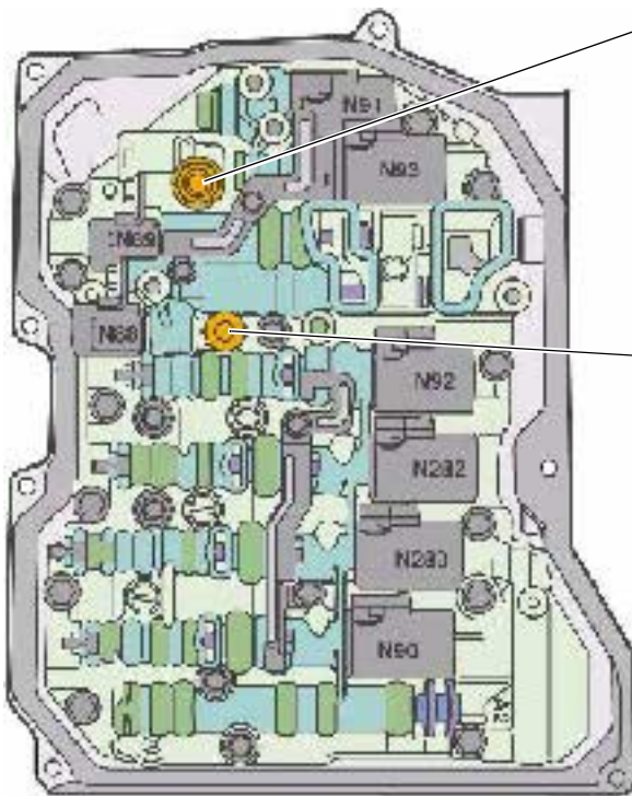
Гидравлический блок управления КП — вид снизу
