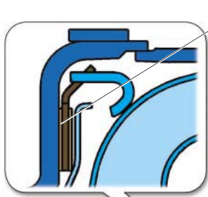
Муфта блокировки гидротрансформатора с двумя накладками
