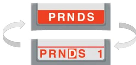
По результатам проведения самодиагностики была обнаружена ошибка (сбой) в системе, которая запускает аварийную или эквивалентную программу, либо эта ошибка просто выводится на индикатор. Водителю необходимо найти ближайшую станцию техобслуживания для устранения неисправности.
