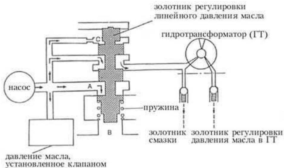
рис. 19. Клапан регулирования линейного давления масла.
