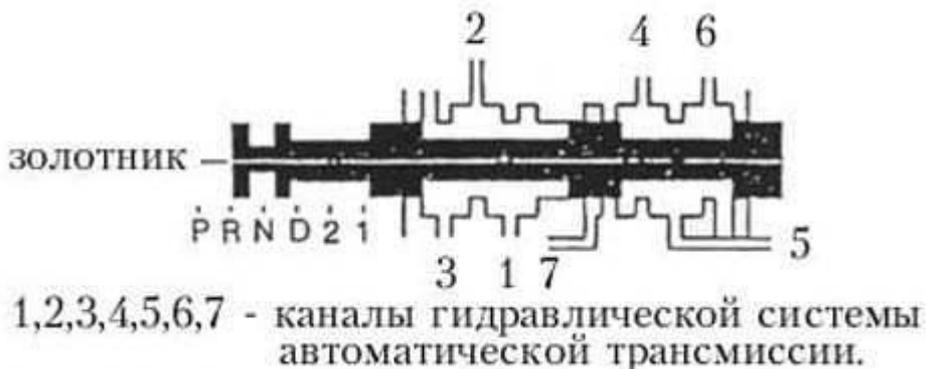
**Рис. 24. Ручной клапан.**
