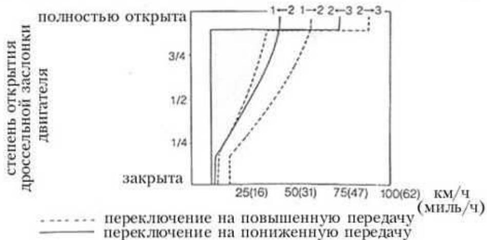
Рис. 29. Принцип действия клапана переключения передач.
